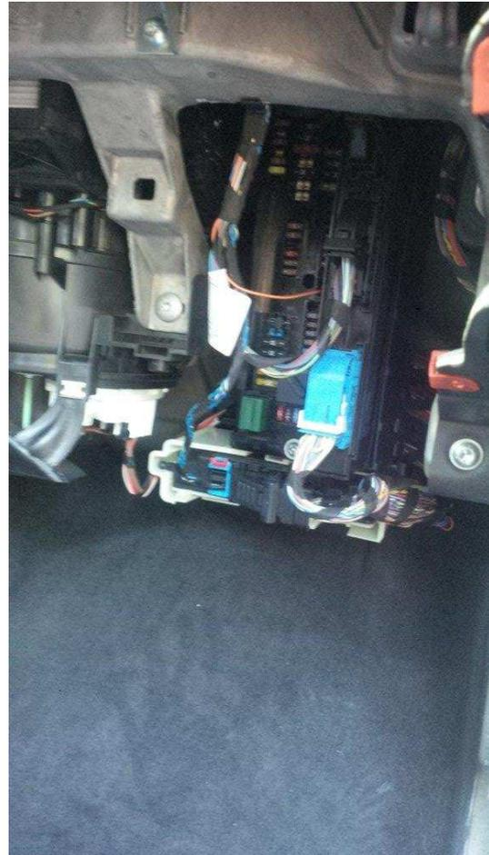
Stromverteiler VR abschrauben und Abzweig A8 (Kabelfarbe RT/GE) des Nachrüstkabelbaumes in PIN 4 des Steckers Z1\*2B (Buchsengehäuse 7-pol.) einpinnen.
