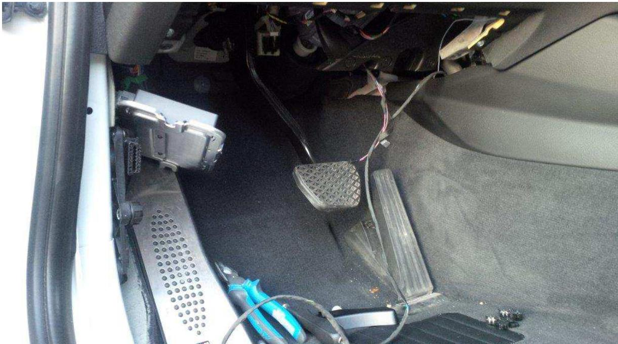
Fußraummodul abschrauben und abstecken. Abzweig A11 (Kabelfarbe SW/GE) und A12 (Kabelfarbe BL/BR) des Nachrüstkabelbaumes mit Miniverbindern (Stromdieben) an den gleichfarbigen Kabeln am Stecker A58\*2B (Buchsengehäuse 51-pol.) anschließen. Das ist der untere Stecker der Beiden. Leider sehr eng und fummelig!
