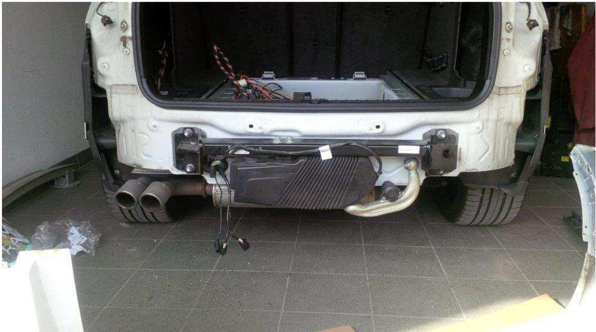
Nachrüstkabelsatz an AHK und PDC anstecken und Stoßfänger in umgekehrter Reihenfolge wieder montieren.
