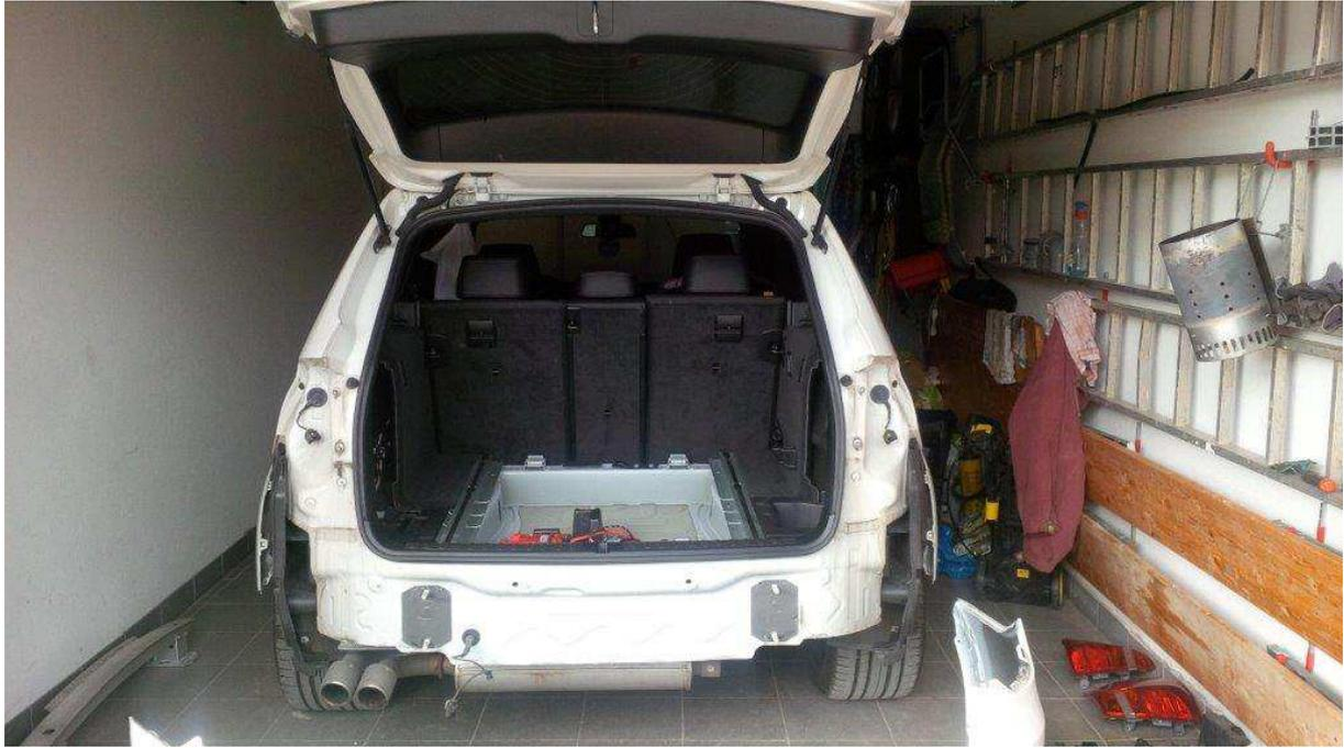
Kabelsatz 61122183657 durch Tülle von PDC mit durchführen bzw. wenn nicht vorhanden 40mm Loch in Karosserie bohren, versiegeln und dort durchführen.
