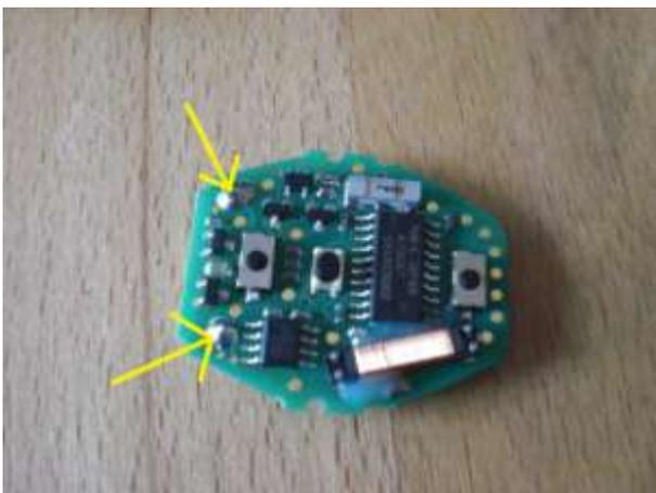
Um den Akku zu lösen muss man die gekennzeichneten Lötstellen entlöten. (sagt man das so....ich weiß es nicht genau). Nach dem entlöten kann das alte Akku entfernt und das Neue wieder eingelötet werden.
