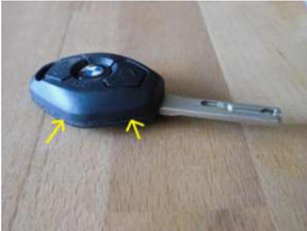
Der Schlüssel muss leider an der Kante aufgeschnitten werden, da das Gehäuse kpl. verschweißt wurde. Ich habe vorsichtig mit einem Cutter rundum aufgeschnitten (Vorsicht mit den Fingern "Schnittwunden")
